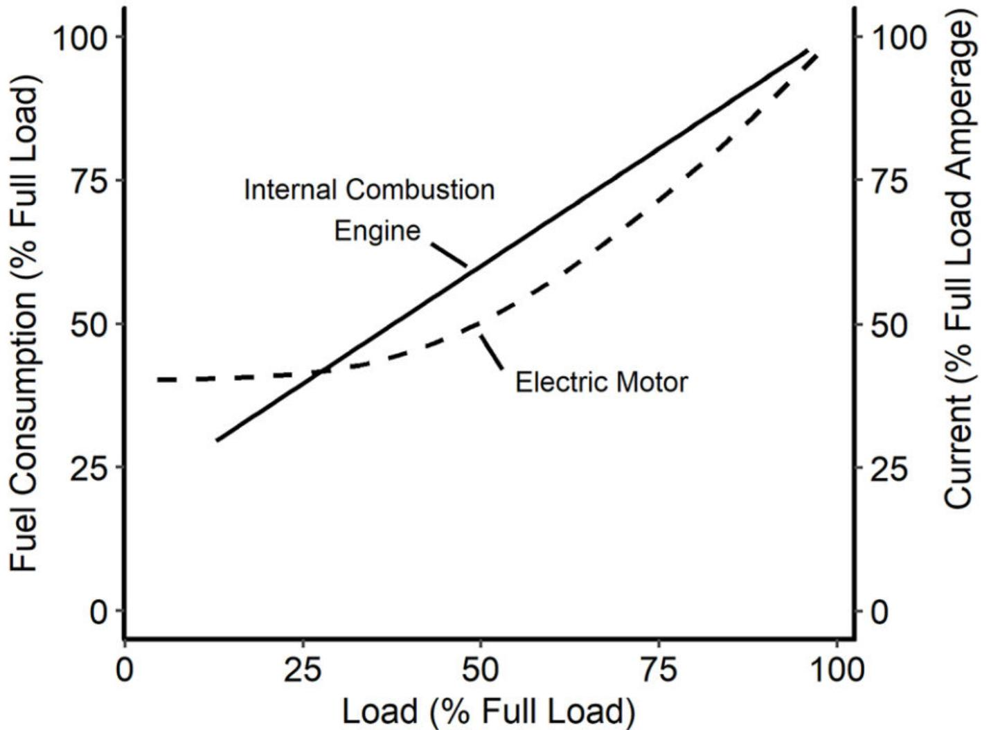
Fig. 1: Carga versus uso de combustible por motores de combustión interna y uso actual por motores eléctricos (preparado con información de [http://dieselserviceandsupply.com/Diesel\\_Fuel\\_Consumption.aspx](http://dieselserviceandsupply.com/Diesel_Fuel_Consumption.aspx) y de <http://energy.gov/sites/prod/files/2014/04/f15/10097517.pdf>).
