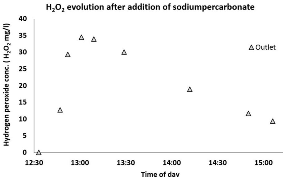
Fig. 2. Concentración de peróxido de hidrógeno medida en relación con la adición de percarbonato de sodio en un estanque de tierra a las 12:35. El volumen del estanque fue de aprox. 100 m<sup>3</sup>; se añadieron 12 kg de CPS correspondientes a una concentración nominal de H<sub>2</sub>O<sub>2</sub> de 39 mg de H<sub>2</sub>O<sub>2</sub>/L. La temperatura del agua fue de 5-5,5 grados-C y el caudal de entrada fue de aproximadamente 15 L/s.
