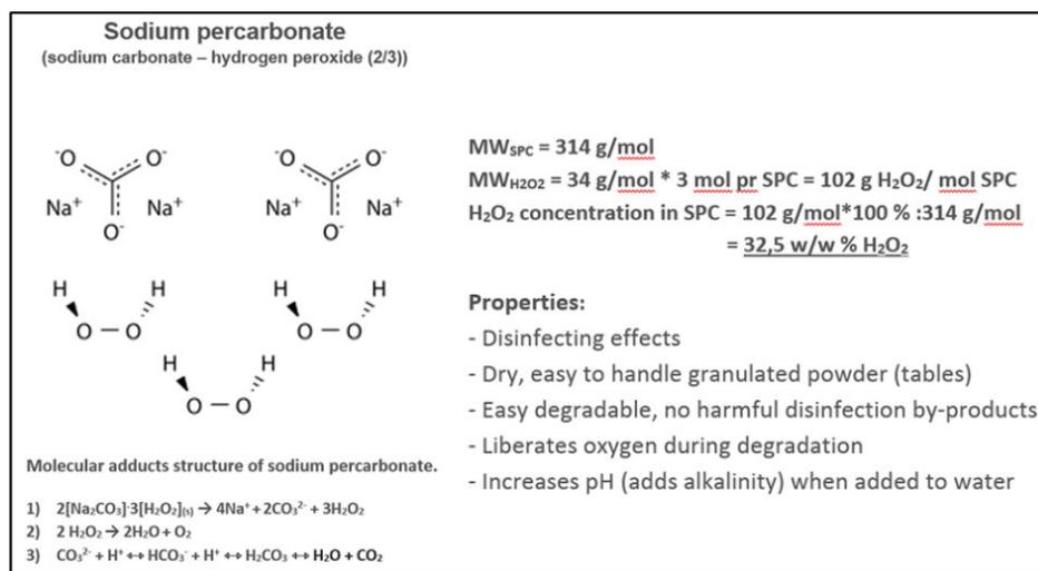
Fig. 1: Estructura molecular y propiedades del percarbonato sódico.
