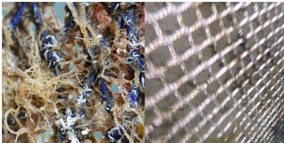
Las nuevas redes acuícolas con iones de cobre (derecha) aumentan la densidad del material y reducen la bioincrustación (izquierda), cuya eliminación es costosa y requiere mucho tiempo. Las partículas metálicas conducen a una liberación continua de una pequeña cantidad de iones de cobre en el agua, lo que reduce el impacto ambiental. Foto cortesía de Garware Technical Fibers Ltd.
