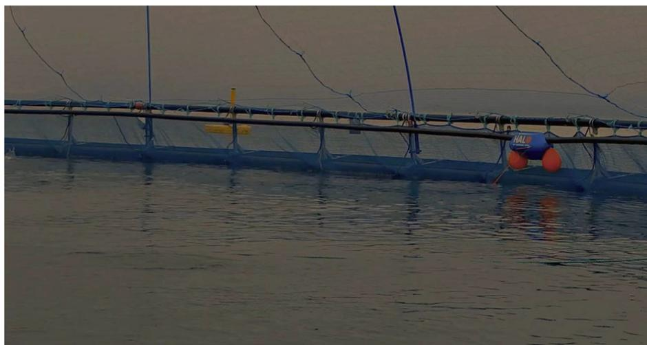
La compañía noruega Aqua Robotics desarrolló un robot que se asienta sobre el agua y recorre la estructura de la jaula, moviendo un sistema de cepillado sumergido que cepilla la red por dentro y por fuera de arriba a abajo. Foto de cortesía.
