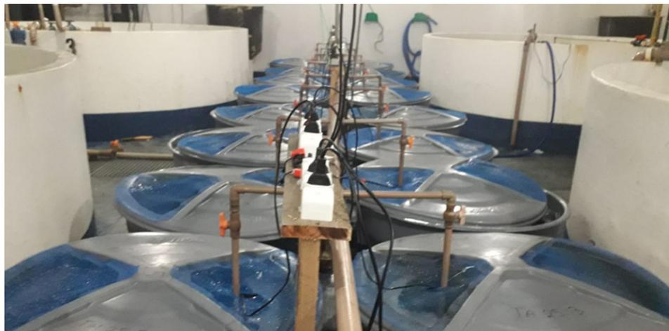
Sistema experimental compuesto por quince tanques aireados de 300 litros que utilizaron mangueras microperforadas y calentadores de agua de 300 vatios para mantener las temperaturas experimentales.
