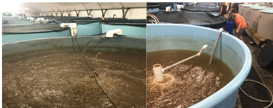
Fig. 1: Diseño de tanque experimental de 1 metro cúbico. El tanque a la derecha, parcialmente drenado, muestra el sistema de circulación impulsado por el puente de aire.
