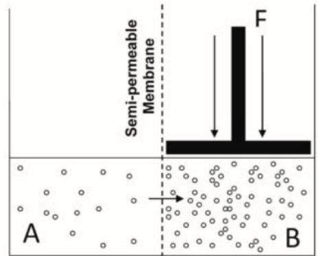
Fig. 2. Ilustración del concepto de presión osmótica.
