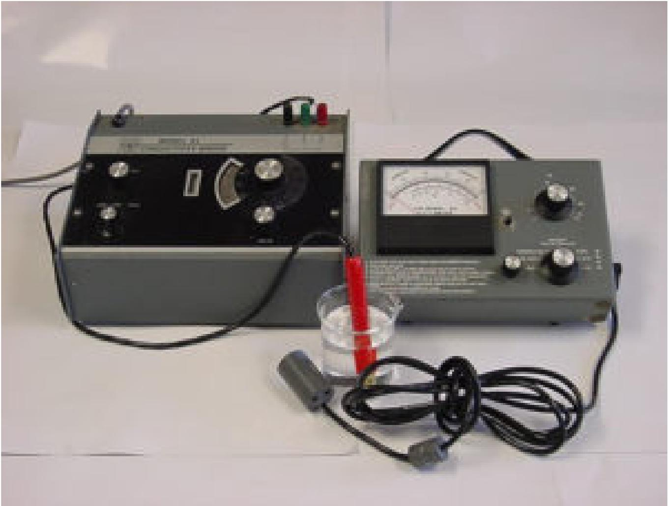
Fig. 1: Un medidor de conductividad de banco de laboratorio (izquierda) y un medidor de conductividad portátil (derecha).
